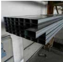
Profilo in ferro ZF - Supporto per fissaggio tamponamento semirigido
