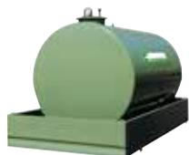
Lamiera d'acciaio in carbonio trattato antiruggine, smalto esterno e selle d'appoggio anti-rotolamento. Passo d'uomo Ø 400 mm per ispezione, dotato di guarnizione e attacco rapido lucchettabile. Scarico di fondo per pulizia periodica. Tubo di aspirazione esterno rialzato e dotato di valvola di non ritorno, filtro e rubinetto. Bacino di contenimento 100%, in acciaio al carbonio predisposto per supporto tettoia.
