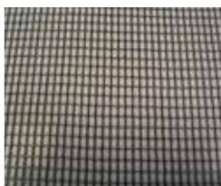
Reti tessute in monofilo, prodotte con polimeri in polietilene ad alta densità e trattate secondo le norme UNIPLAST. - Colori disponibili: verde e nero - Stabilizzazione ai raggi UV- Misure standard 100-150-200-250-300-400-450-500-600 cm (Misure superiori mediante cucitura)
