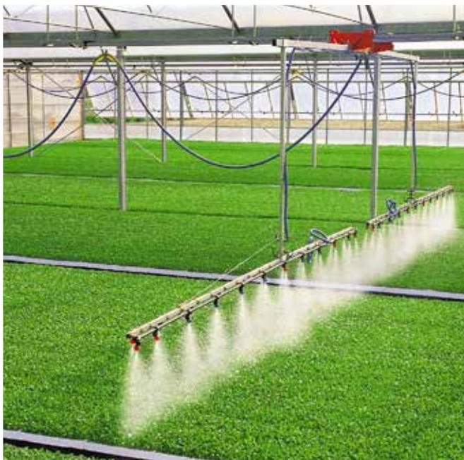
Si tratta di sistemi semoventi in grado di distribuire acqua e fertilizzanti dall'alto.
